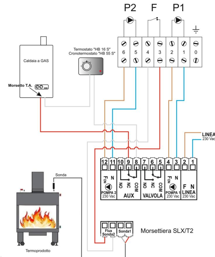
Quando viene installato il modulo mini e cioè quello con un solo circolatore, è necessario utilizzare la pompa nr. 2 della centralina: l'uscita ausiliaria «AUX» e l'adeguato funzionamento del flussostato è legata all'attivazione della pompa nr. 2.
